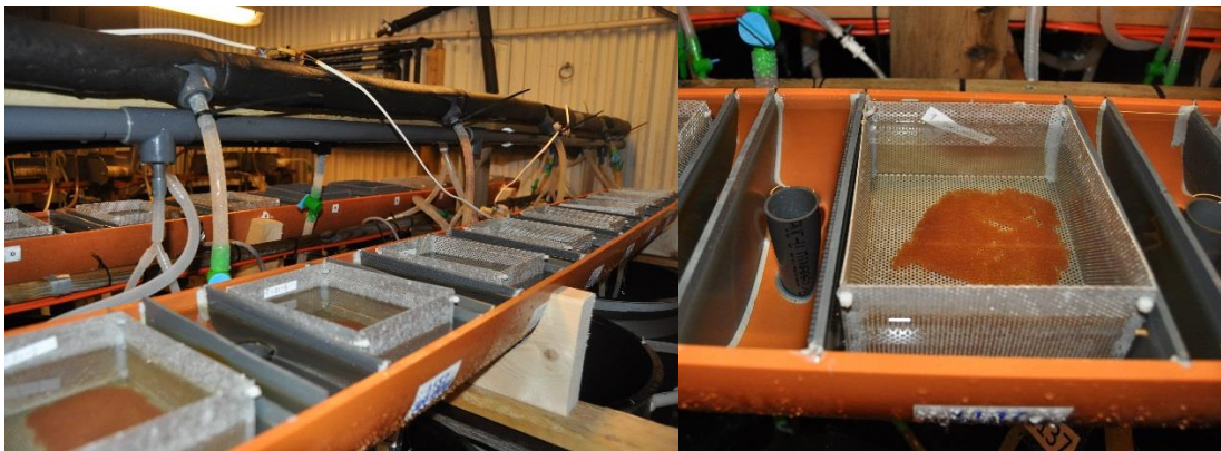
Figur 5. Bildene viser klekkerenue med 11 separate klekkeceller med egne inn- og utløp.
